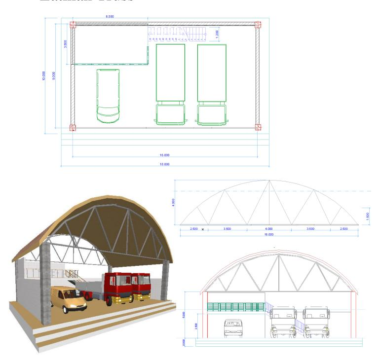
Ukuran Kolom 50/50, tebal tembok 15 cm, untuk kendaraan mengunakan objek tool yaitu lorry dan van, untuk pagar menggunakan rail wired, dan tangga menggunakan stair straight, ukuran yang belum ada sesuaikan sendiri
